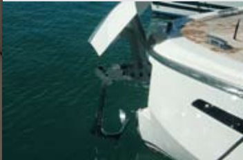
El diseño del modelo brilla en proa con un ingenioso sistema eléctrico que permitirá extraer o guardar el ancla.
